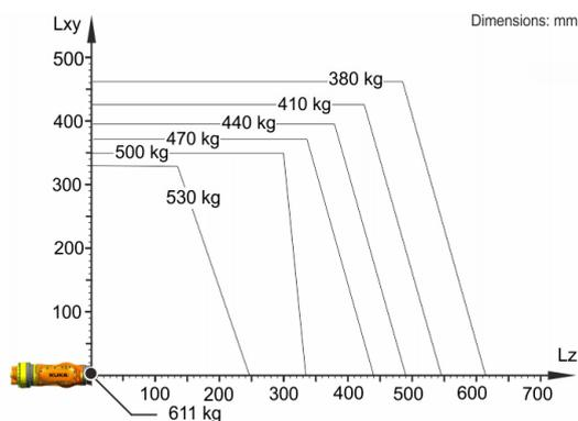
Il KR 500 R2830 MT-F è progettato per una portata nominale di 500 kg in grado di sfruttare al meglio le prestazioni e la dinamicità del robot. Il carico utile massimo di 611 kg vale solo quando sono applicati una posizione di carico del baricentro di 0 mm e un carico aggiuntivo ottimizzato per la situazione di carico. La situazione di carico specifica deve essere verificata con KUKA.Load o KUKA Compose. Per un'ulteriore consulenza il servizio di assistenza KUKA rimane a vostra disposizione.
