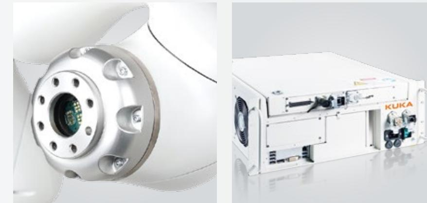
**Medienflansch inside electrical Med:** Über den Medienflansch inside electrical Med stehen für kundenspezifische Tools am Flansch Anschlüsse z. B. für Stomversorgung, I/Os oder Ethernet zur Verfügung.
