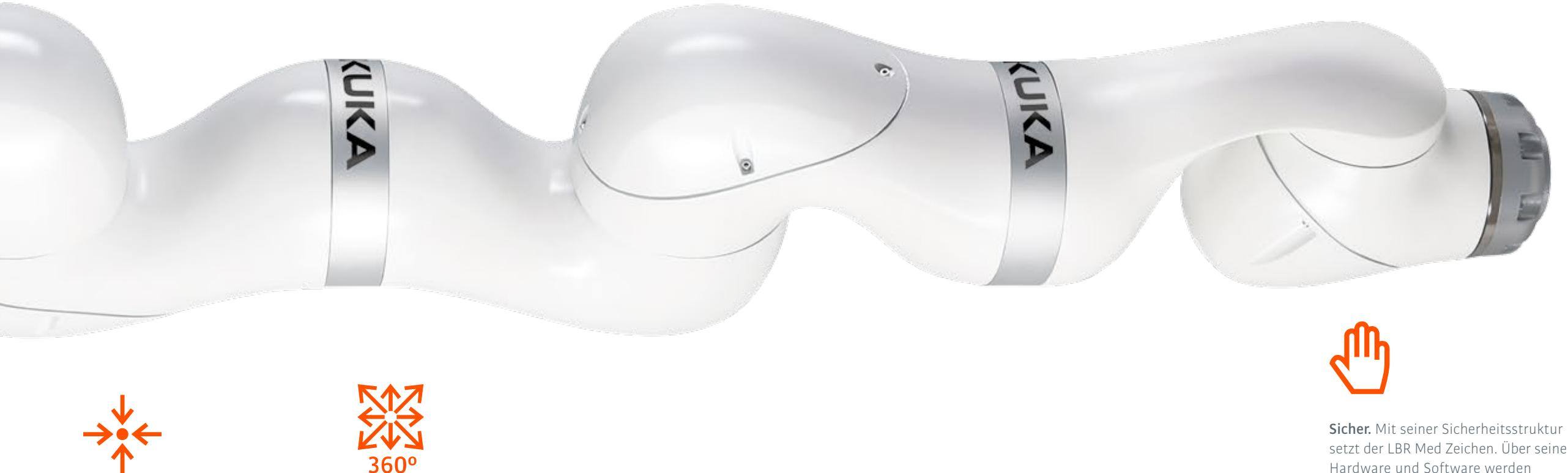
**Präzise.** Zur Kalibrierung und für hochpräzises Arbeiten braucht der LBR Med keine zusätzlichen Geräte. Dank integrierter Justagesensoren kalibriert er sich ganz autonom und erreicht eine hervorragende Wiederholgenauigkeit von  $\pm 0,1\text{ mm}$  bis  $\pm 0,15\text{ mm}$ .
