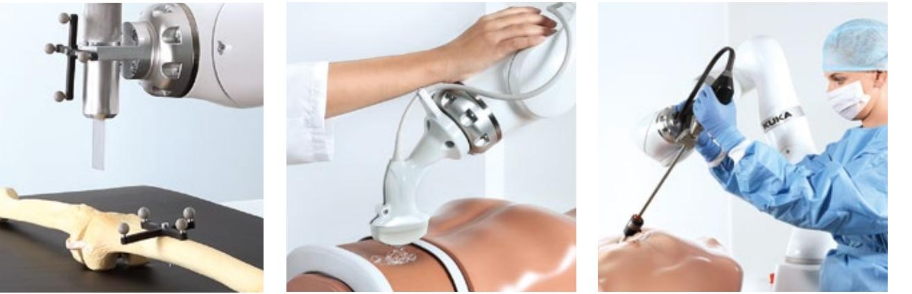
**Orthopädische Chirurgie:** Dank seiner stabilen Ausführung und Konstruktion sowie seiner hohen Steifigkeit eignet sich der LBR Med für die Knochenchirurgie. Open-Source-Bibliotheken erleichtern die schnelle Entwicklung von Prototypen sowie die Integration von Navigationskameras.
