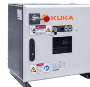
Das KR C5 micro cabinet ist die fertige Steuerungskomponente in Schutzart IP54 für den Betrieb von KUKA Kleinrobotern und bietet optional auch Platz für kompakte Zusatzachsen und weiterführende Peripheriefunktionen.
