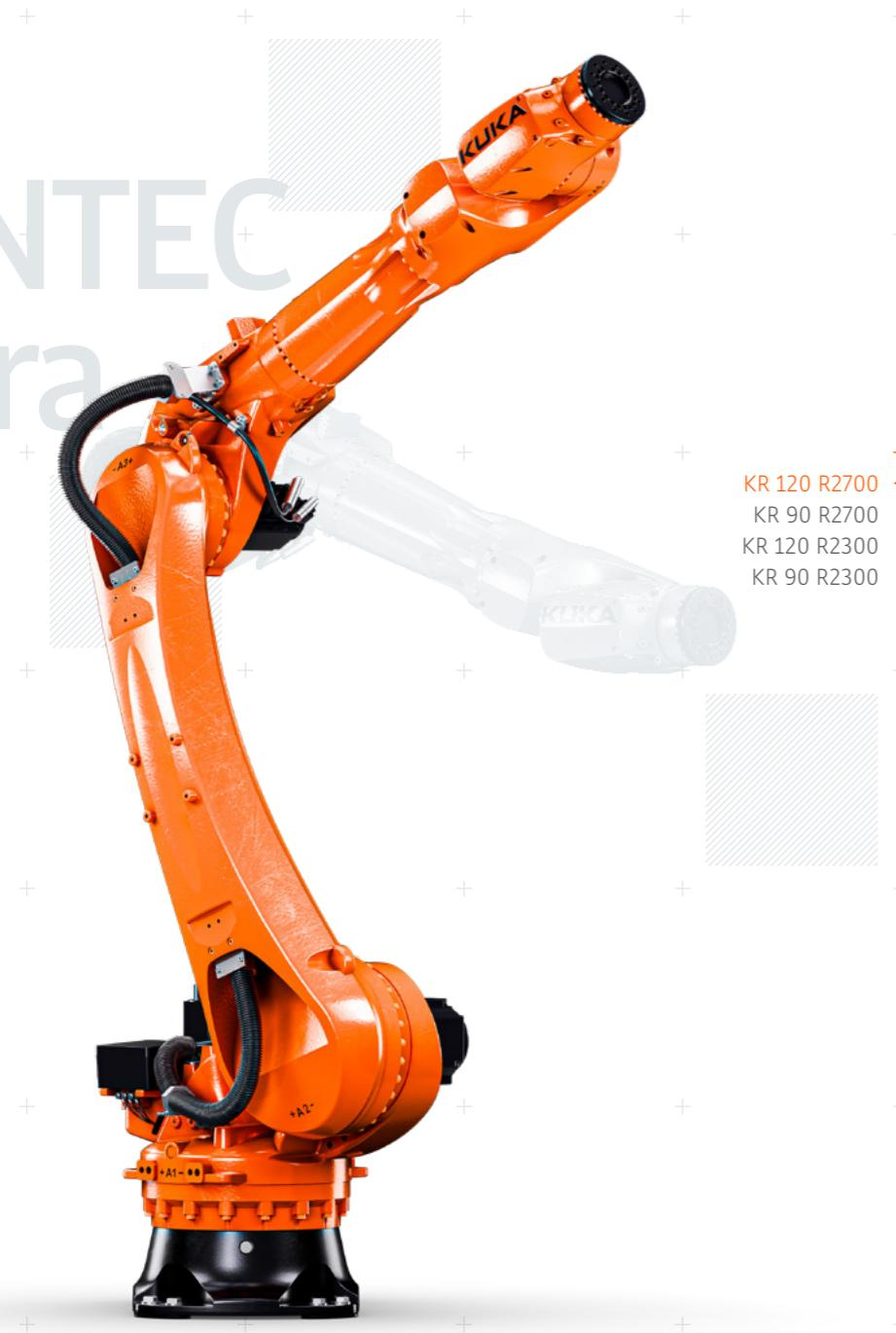
**KR IONTEC ultra** Der KR IONTEC ultra ist kompakt und leistungsstark. Im Traglastbereich von 90 bis 120 Kilogramm bringt er auf engstem Raum Höchstleistungen – optimal für Handling- und Schweiß-Applikationen.
