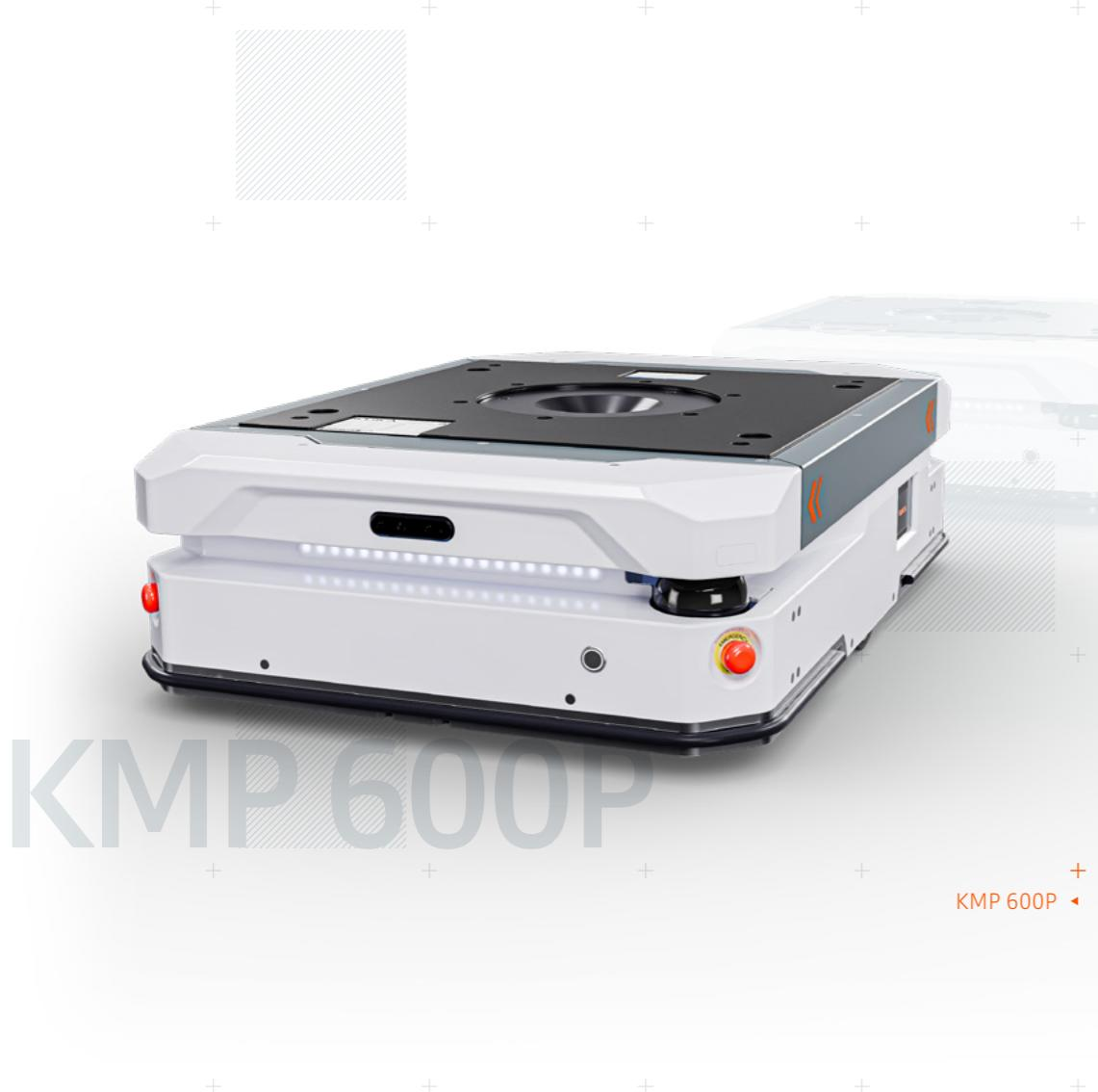
**KMP 600 P** Die KMP 600P ist ein kompakter Allrounder, der bis zu 600 Kilogramm transportieren kann und besonders für enge Produktionsumgebungen geeignet ist. Der autonome mobile Roboter (AMR) bietet ein ausgezeichnetes Preis-Leistungs-Verhältnis und ermöglicht durch induktives Laden den 24/7-Betrieb sowie eine verlängerte Batterielebenszeit.
