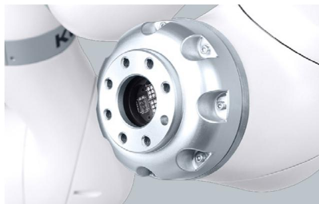
**Medienflansch inside electrical Med.** Über den Medienflansch inside electrical Med stehen für kundenspezifische Tools am Flansch Anschlüsse z. B. für Stromversorgung, I/Os oder EtherNet zur Verfügung.
