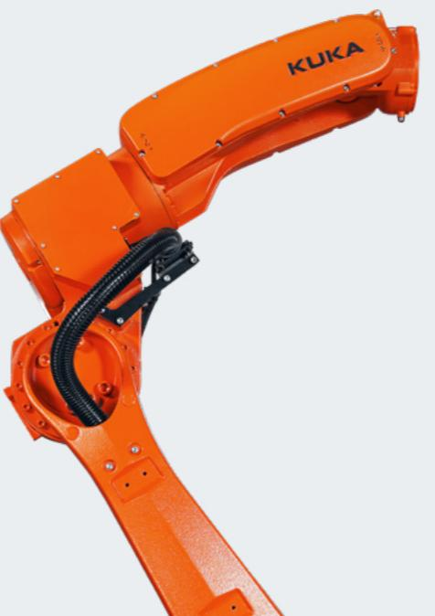
**KR CYBERTECH nano ARC E.** Der Edition Roboter markiert den Einstieg in die Welt der Schweiß-Automation. Er wurde speziell für einfache Schweißaufgaben geschaffen. Bei Prozessen geringer Komplexität ist es dank dem KR CYBERTECH nano ARC E möglich, eine roboterbasierte Automation sehr wirtschaftlich zu realisieren. Dabei macht er in Sachen Qualität, Zubehör oder Software keine Kompromisse.
