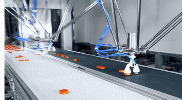
PickControl ist ein nachladbares Optionspaket zur Steuerung, Verwaltung und Überwachung von Pick&Place-Anlagen. Teile mit beliebiger Orientierung und Lage können mit PickControl von einem oder mehreren Robotern schnell gegriffen und geordnet wieder abgelegt werden. Die Teile können von unterschiedlicher Form und Größe sein. Der Arbeitsbereich kann ein fester Arbeitsbereich (z. B. eine Ablage) oder bewegter Arbeitsbereich (z. B. ein Förderband) sein.
