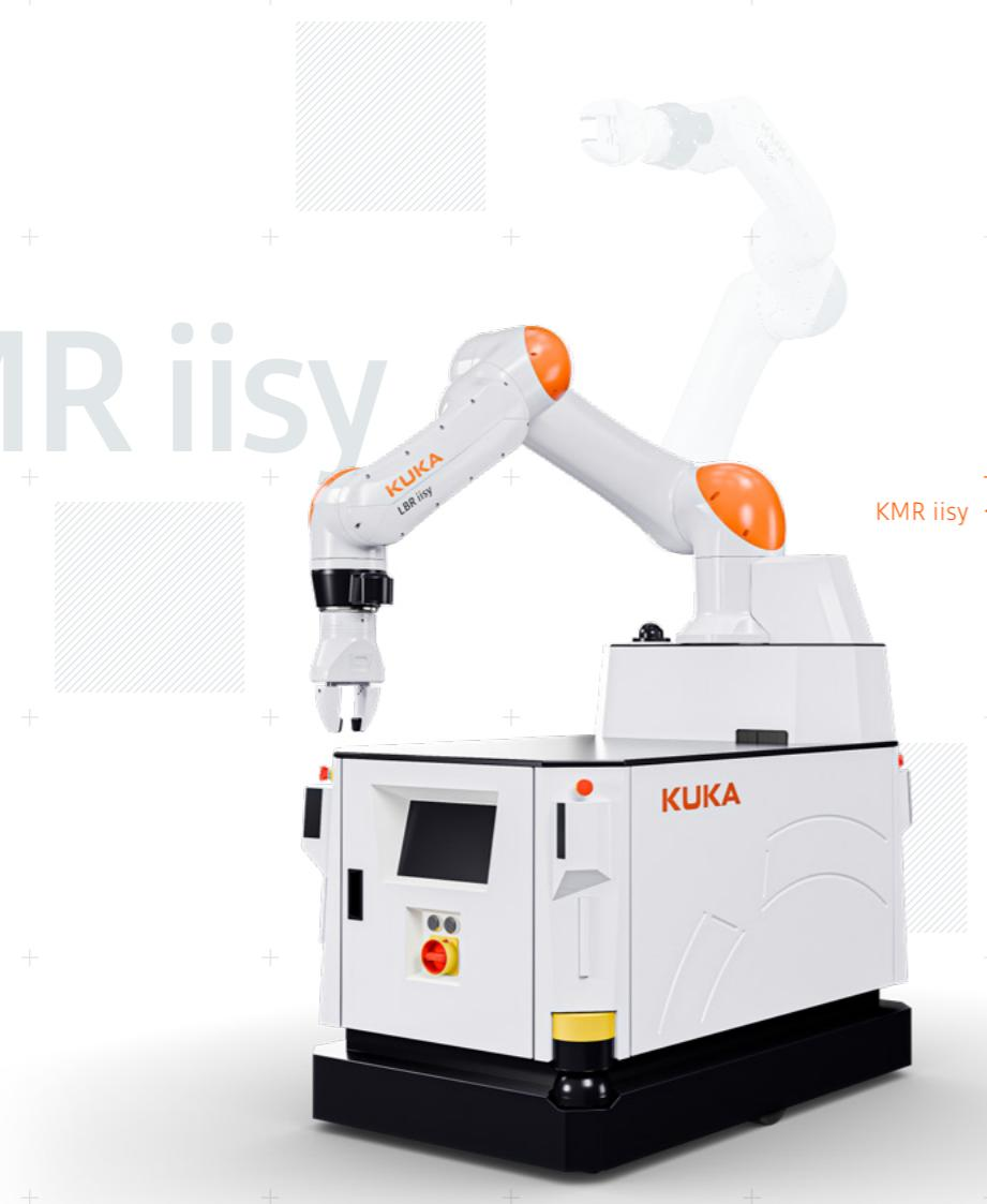
**KMR iisy** Autonom, flexibel einsetzbar und alle Hindernisse im Blick – der KMR iisy ist als vollintegrierte Kombination aus Roboter und Transportplattform ein smarter Partner in Lagerlogistik und Produktion.
