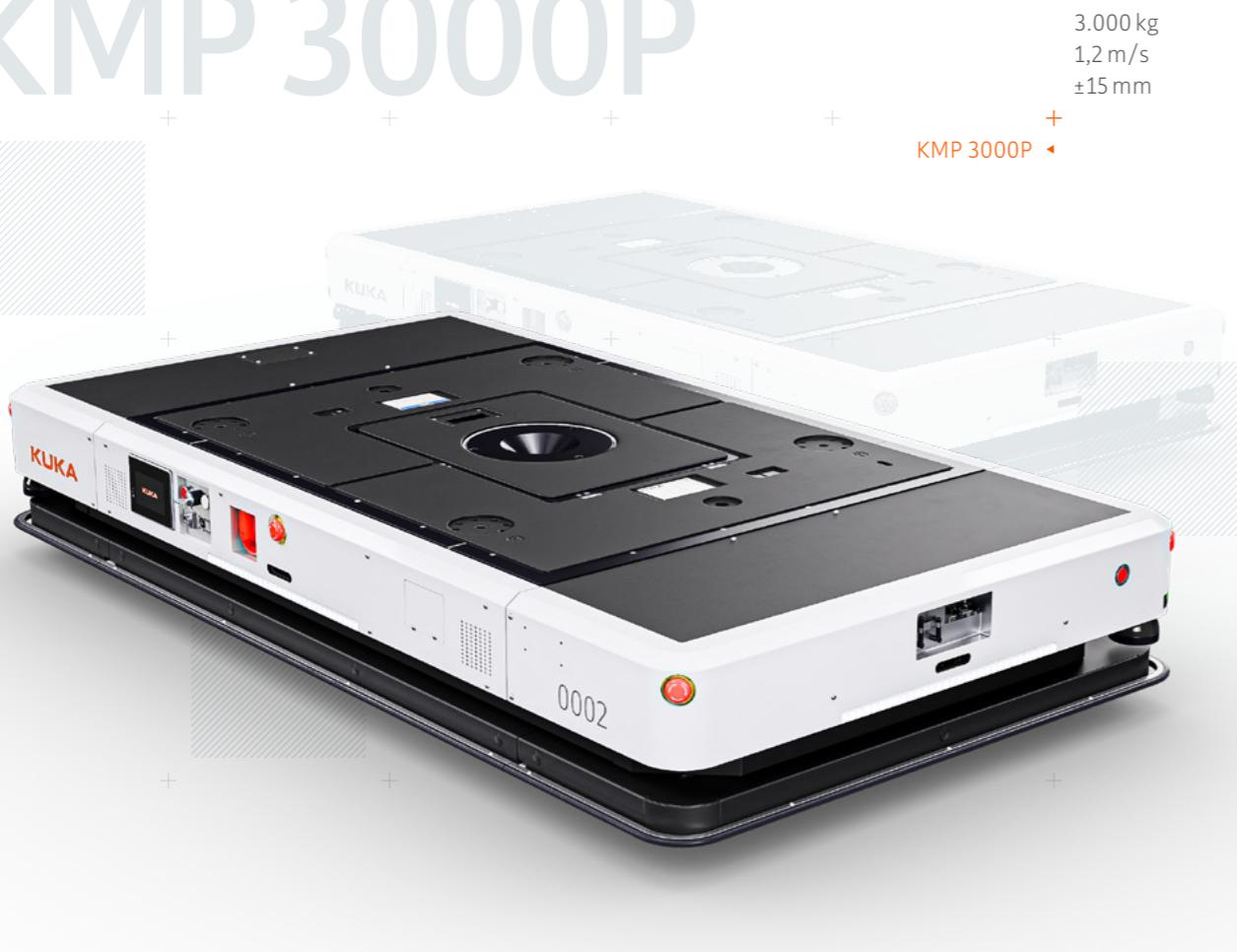
**KMP 3000P** Die autonome mobile Plattform transportiert die Schwergewichte in der Produktion und Intralogistik. Sie trägt bis zu drei Tonnen und bewegt sich dabei omnidirektional im Raum. Durch ihr neues induktives Ladekonzept ist die KMP 3000P rund um die Uhr betriebsbereit. Integrierte 3D-Kameras und Laserscanner sorgen für Flexibilität und Sicherheit in einer Arbeitsumgebung mit Menschen.
