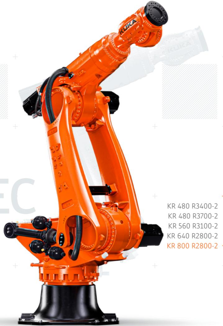
**KR FORTEC ultra** Die Schwerlastroboter mit Traglasten von bis zu 800 Kilogramm bieten maximale Leistung auf kleinstem Raum und zeichnen sich durch ein schnelles und präzises Handling von großen Bauteilen mit hohen Trägheitsmomenten aus.
