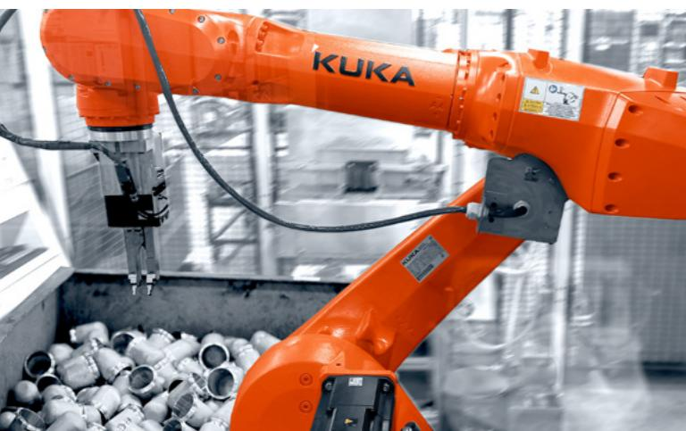
**KUKA.SmartBinPicking.** Mit der intelligenten Software-Erweiterung KUKA.SmartBinPicking gelingt auch das Greifen und Umsetzen von lose in Behältnissen liegenden Objekten schnell und unkompliziert. Zur Visualisierung nutzt das System eine 3D-Umgebung. Bewegungen werden auf Basis einer leistungsfähigen Bibliothek bestimmt.
