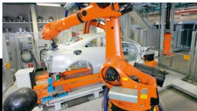
Souder, usiner, prélever des pièces en fonte ou, comme ici, mesurer en ligne des carrosseries ne représentent qu'une fraction des possibilités d'application.
