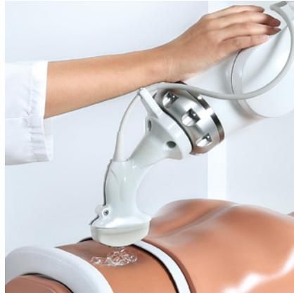
**Ultraschalldiagnostik:** Sensitive Technologie und sichere Mensch-Roboter-Kollaboration sind die Domäne des LBR Med. Dank der integrierten Sensorik kann er sowohl interaktiv mit dem Arzt als auch telemanipuliert auf seine Umgebung reagieren.
