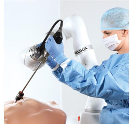
**Minimalinvasive Chirurgie:** Die hochentwickelte Steuerung ermöglicht präzises Agieren unter Berücksichtigung einer Trokarkinematik. Der Benutzer kann frei wählen, ob er die Applikation automatisiert, interaktiv oder telemanipuliert betreibt.
