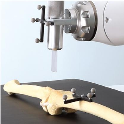
**Orthopädische Chirurgie:** Dank seiner stabilen Ausführung und Konstruktion sowie seiner hohen Steifigkeit eignet sich der LBR Med für die Knochenchirurgie. Open-Source-Bibliotheken erleichtern die schnelle Entwicklung von Prototypen sowie die Integration von Navigationskameras.
